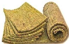
smanjenja nepoželjne buke u radnim i stambenim prostorijama koja potječe od vlastitog ili vanjskog izvora buke. Od tih materijala tražimo izolaciju od zračnog zvuka i od udarnog zvuka. Kao zvučno izolacijski materijali upotrebljavaju se i kamena i staklena vuna, poliuretanska pjena, polistiren (elastificirani), drugi slični proizvodi.
