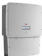
**Fotonaponski izmjenjivač (inverter)** je multifunkcionalni uređaj i glavna poveznica između fotonaponskih modula i elektrodistribucijske mreže. Primarni mu je zadatak pretvorba istosmjerne struje sa izlaza fotonaponskog polja u izmjeničnu, prikladnu za slanje u zgradu ili elektroenergetsku mrežu. Izmjenjivači omogućuju i dodatne funkcije, kao nadstrujnu i prenaponsku DC i AC zaštitu, mogućnost isporuke jalove snage, i sl.
