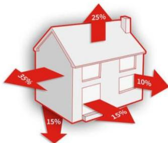
Promatra li se zgrada kao objekt, može se iz njezine geometrije vidjeti da najveći dio ploštine otpada na vanjske zidove, zatim na krov i podove te na kraju na otvore. Promatra li se udio pojedinih toplinskih gubitaka na toj istoj zgradi koja je uz to i nedovoljno toplinski izolirana, može se uočiti da najveći dio gubitaka otpada na vanjske zidove i krove/stropove, a manji dio na otvore i podove.
