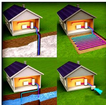
Dizalice topline rade na principu ljevokretnog (Carnotovog) kružnog procesa gdje preuzimaju toplinsku energiju niže temperaturne razine iz okoliša (zrak, tlo, voda) te je uz pomoć utrošene električne energije za pogon kompresora dižu na višu temperaturnu razinu i predaju sustavu grijanja/hlađenja/ventilacije/pripreme potrošne tople vode.
